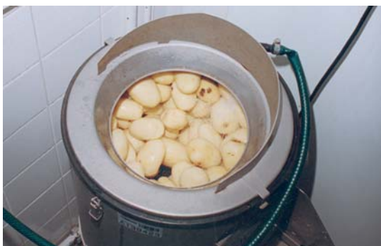
Kuva: Perunan karborundum-kuorinta
